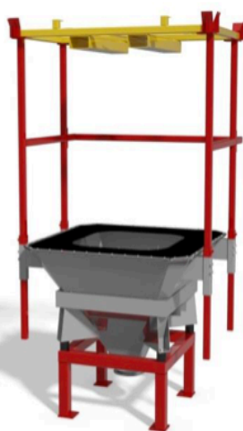
BAGBOY ONE WAY typ B Golvstativ (10b) med tömmar- skål (4), gummimanschett (3), kniv (2), säckupphängningsstativ (1b) och ok för truck eller kran (18c).
