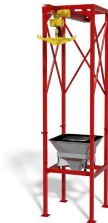
BAGBOY ONE WAY typ C Traversstativ (10c) med tömmar- skål (4), gummimanschett (3), kniv (2), eldriven kättingtelfer (17) och lyftok (18a).
