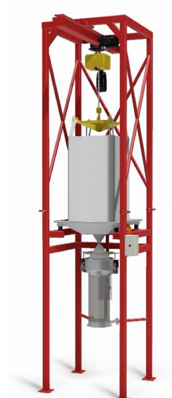
BAGBOY HYGIEN Gen. II typ C Traversstativ (10c) med säckstöd (4b), eldriven kättingtelfer (17) och lyftok (18a). Klämenhet (21) för fixering och sträckning av tömningsstos, styrd från ett pneumatiskt styrsåp (20).
