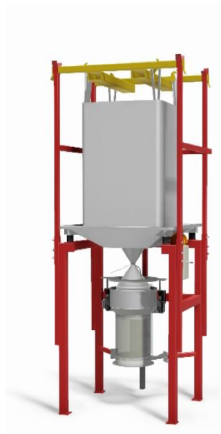
BAGBOY HYGIEN Gen. II typ B Golvstativ (10b) med säckstöd (4b), säckupphängningsstativ (1b) och ok för truck eller kran (18c). Klämenhet (21) för fixering och sträckning av tömningsstos, styrd från ett pneumatiskt styrsåp (20).
