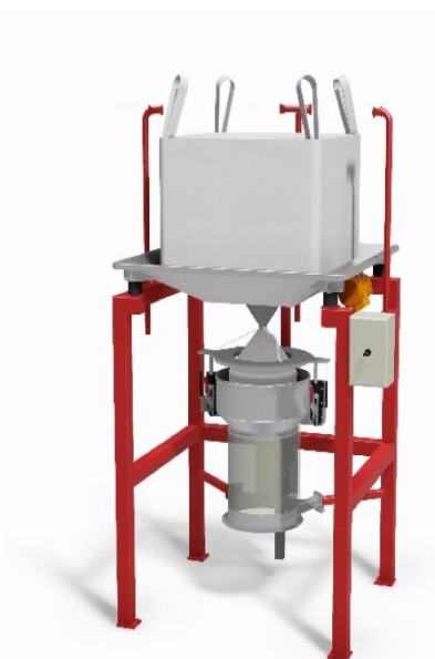
BAGBOY HYGIEN Gen. II typ A Golvstativ (10a) med säckstöd (4b) och centreringsarmar (1a). Klämenhet (21) för fixering och sträckning av tömningsstos, styrd från ett pneumatiskt styrsåp (20).
