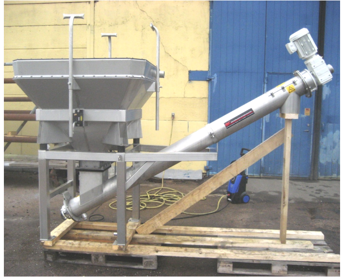
Storsäckstömmare med skruv till offshore-industrin.
