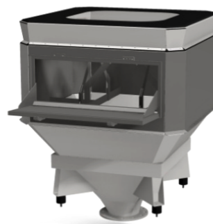
Förhöjd tömmarskål (4a) för ökad volym och lucka för småsäckstömning (19).
