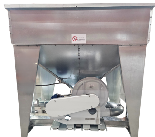
Fläkten sitter inuti för att skyddas (borttagen plåt)
