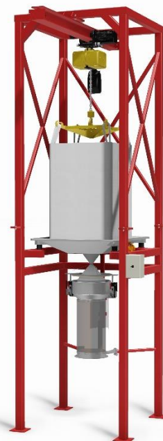
BAGBOY HYGIEN Gen. II typ C Traversstativ (10c) med säckstöd (4b), eldriven kättingtelfer (17) och lyftok (18a). Klämenhet (21) för fixering och sträckning av tömningsstos, styrd från ett pneumatiskt styrskåp (20).
